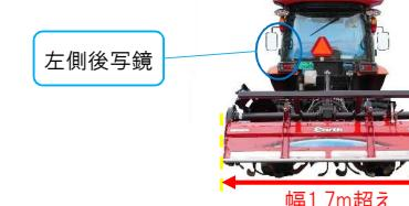
② 農耕トラクタ単体の大きさを含め、農作業機を装着した状態で幅が2.5mを超えていないか確認しましょう。
