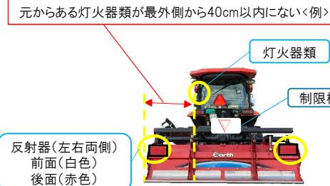
※道路運送車両の保安基準により、各種灯火器類の取り付け位置は以下のように定められています。
