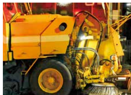
路側の土砂を回転ブラシで取り除く車両
