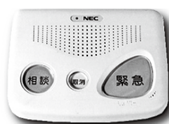
緊急通報装置
