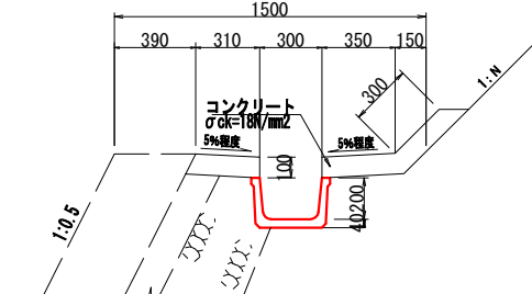
4号U型側溝 材料表 10m当り
